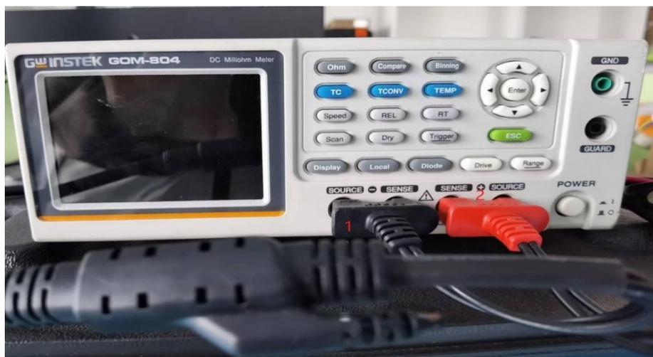
1 和 2 分别连接着绕组温升测试仪的测试端。
