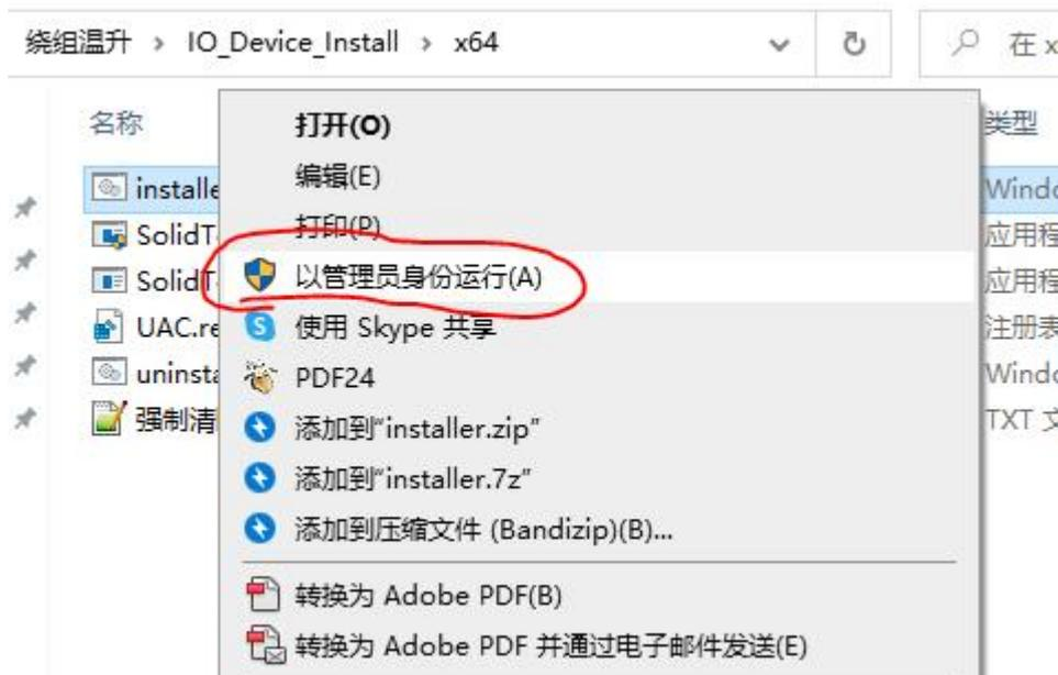
根据电脑系统参数选择 X32 或者 X64 文件夹，右键“以管理员身份运行”，安装完驱动后，在设备—服务内会有一个“SolidTechService”的服务在运行，即完成驱动安装。
