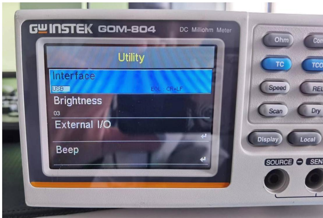
电阻计面板操作 **System>Utility** 设置到 USB 选项。电脑 PC 需安装 USB 驱动。
